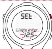
Presionar la tecla START/STOP. Se muestra "límite inferior". El valor ingresado parpadea.
